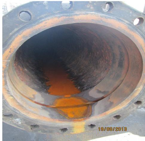
Foto 11.16: La tubería de bombeo presenta corrosión
